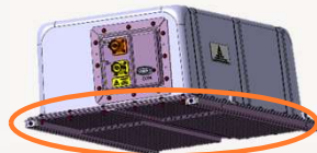
Aletas expanden el área de disipación
