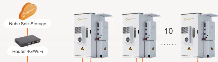
Hasta 10 unidades de PrimePower conectadas en modo paralelo en el lado de CA
